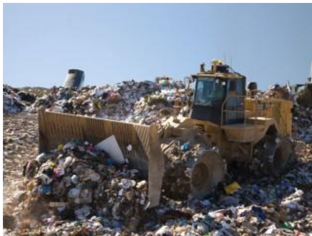
Slika 31. Prikaz rada kompaktora na deponiji
